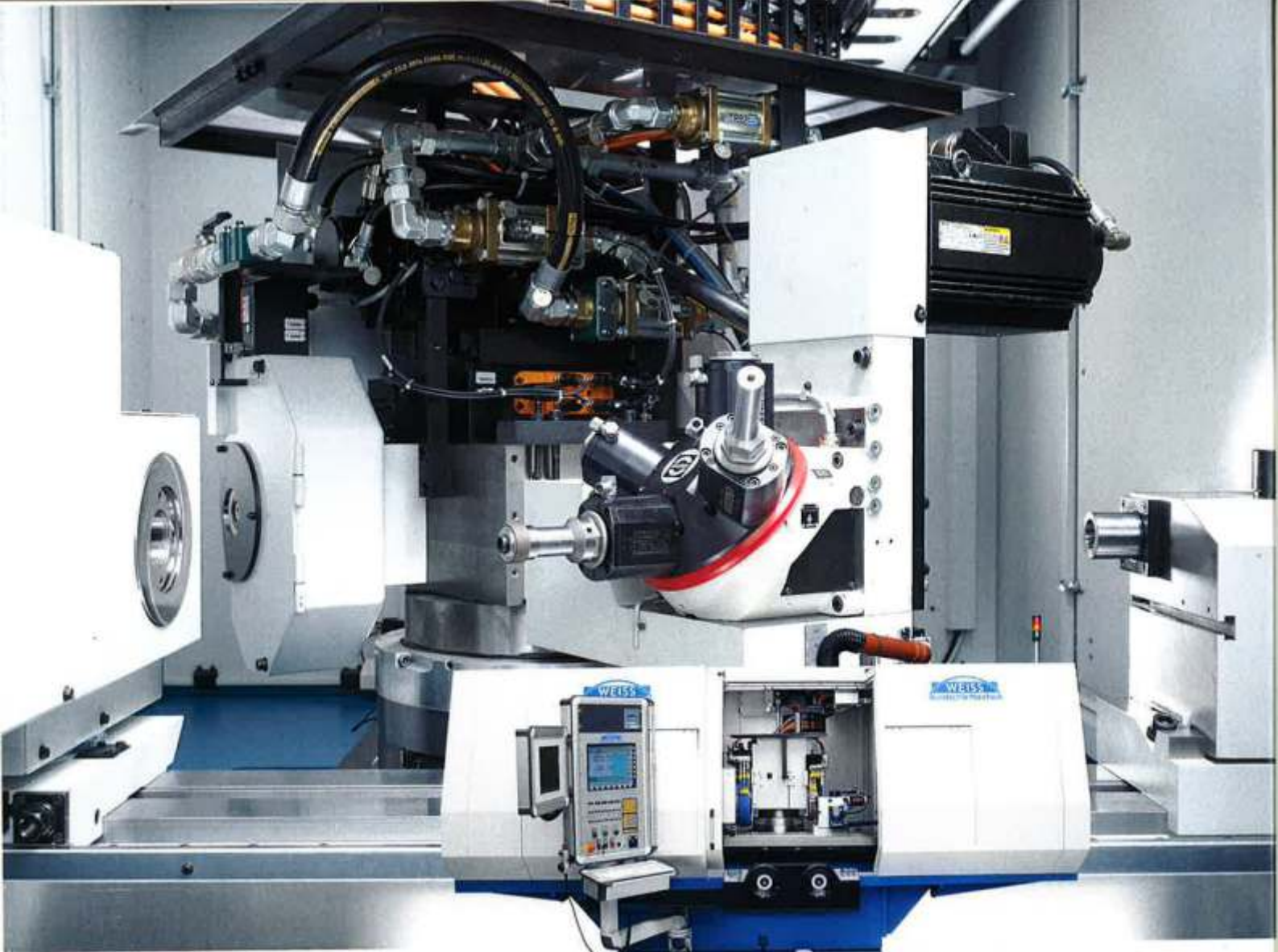
4-fach Revolver zum Innenschleifen für komplexe Schleifaufgaben in einer Aufspannung.
